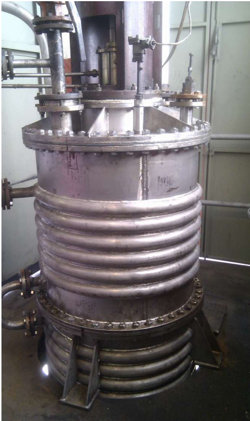
Reaktor DPG z niklových slitin Lučební závody Draslovka 5/2013
