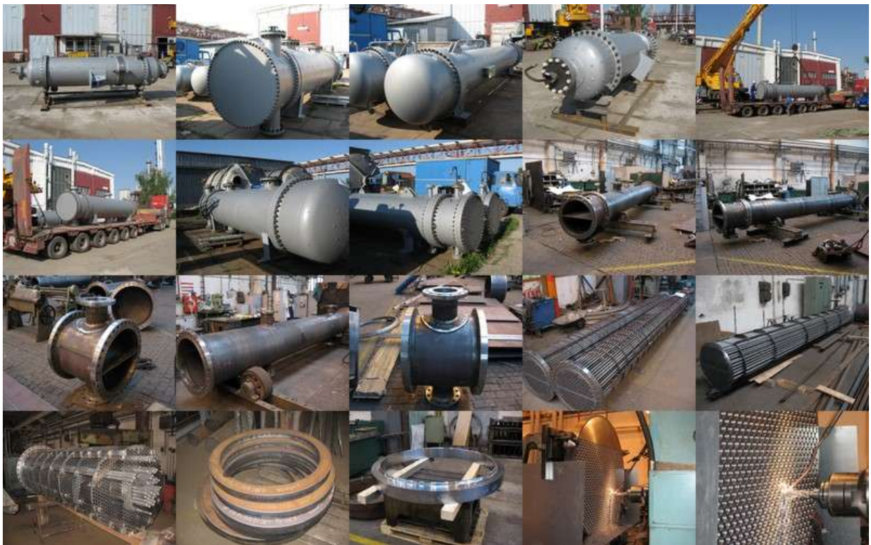
Výroba 19ks trubkových výměníků Buthadien II. P265GHChemoprojekt (Synthos Kralupy) 5/2006
