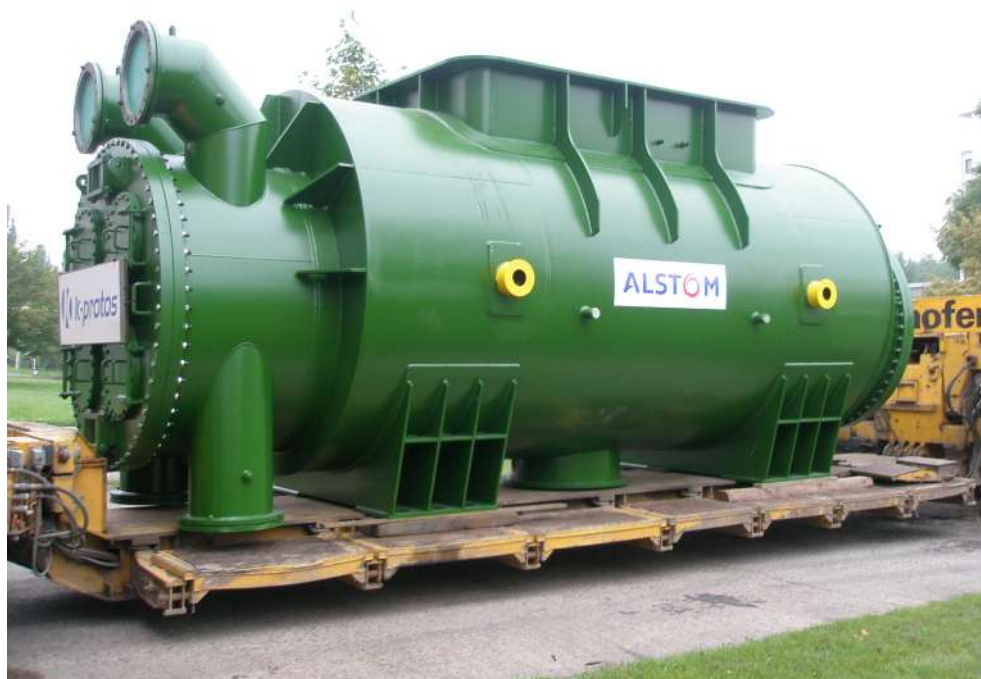
Kondenzátor P265GH ALSTOM/UNIPETROL 9/2006
